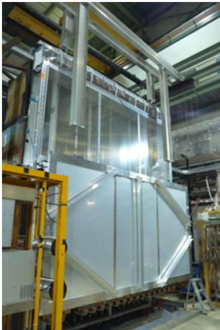
新たに製作したドリフトチェンバー
