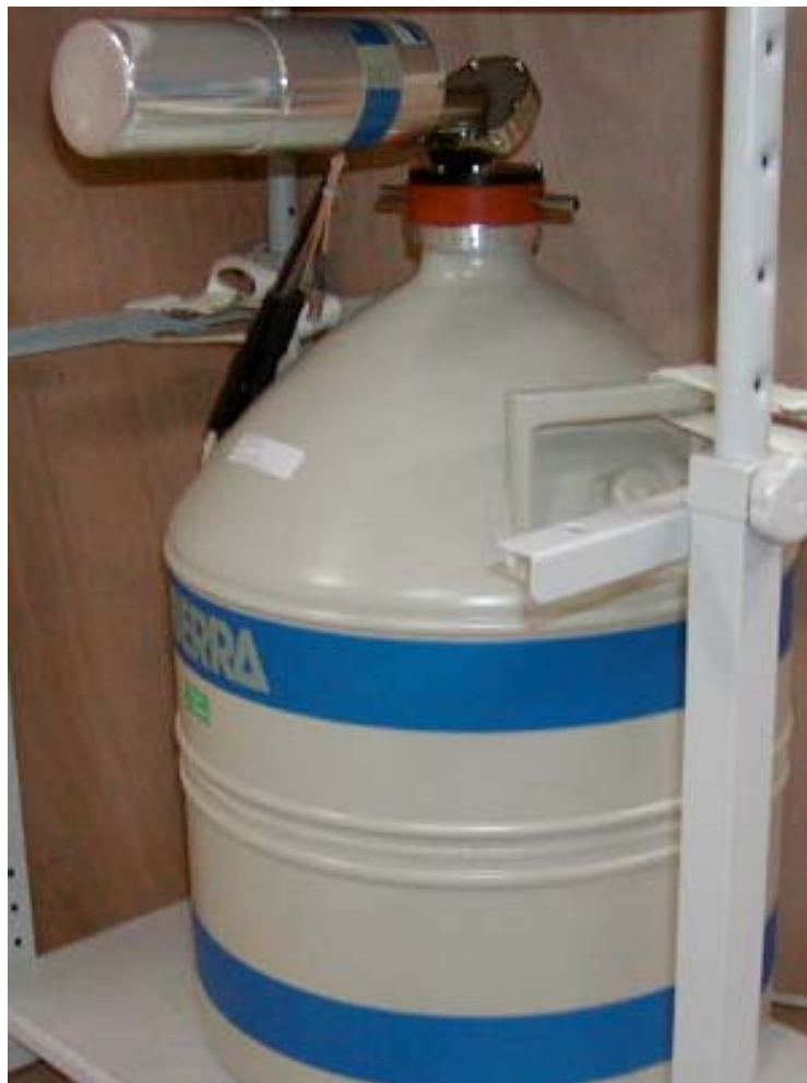
終端閉鎖同軸型 高純度ゲルマニウム半導体検出器 (Closed-end coaxial High Purity Ge semiconductor detector)
